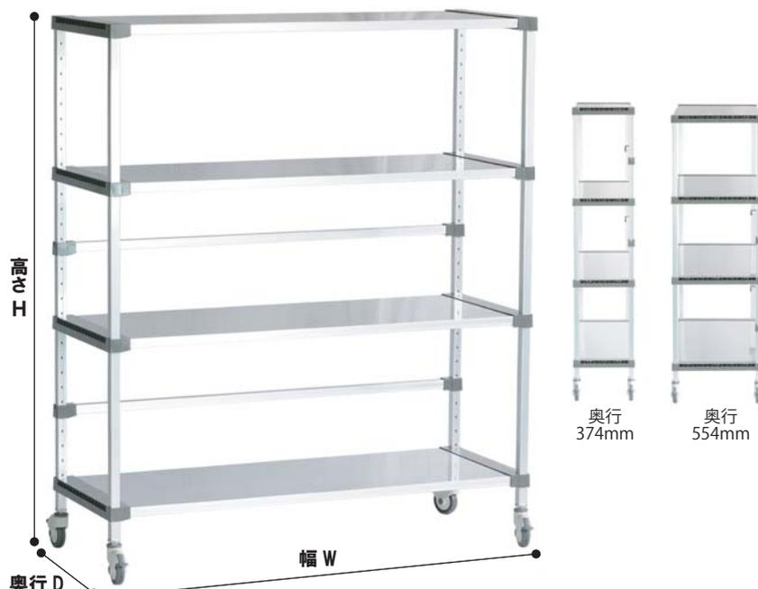
支柱及びフレームは30×30mmの角形状、棚板の厚みは30mmです。棚板高さの間隔は50mmピッチで自由に変えられます。
