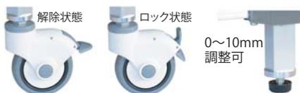
キャスターは直径100mmの大型キャスターを使用。車輪は色の移行がなく静音性も良好なエラストマー製で全車ストップパー付きです。アジャスターは0~10mm調整可能。ナイロン製です。
