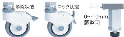
キャスターは直径100mmの大型キャスターを使用。車輪は色の移行がなく静音性も良好なエラストマー製で全車ストッパー付きです。アジャスターは0~10mm調整可能。ナイロン製です。
