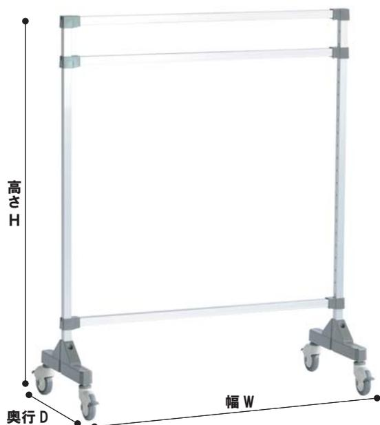
支柱及びフレーム、バーは30×30mmの角形状です。フレームの高さ間隔は50mmピッチで自由に変えられます。
