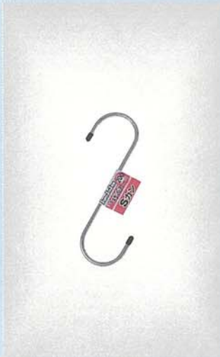
SK200C 18-8ステンレスSカン200mm ①A: 200 B: 50 C: 50 ②5.0φ ③本体巻シール ④20/120入 ⑤5kg ⑥4530770440332 ⑦塩化ビニールキャップ
